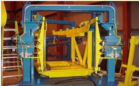
Fig. 17: Transferencia 45°, devuelve los blanks al proceso desde el carrusel.
